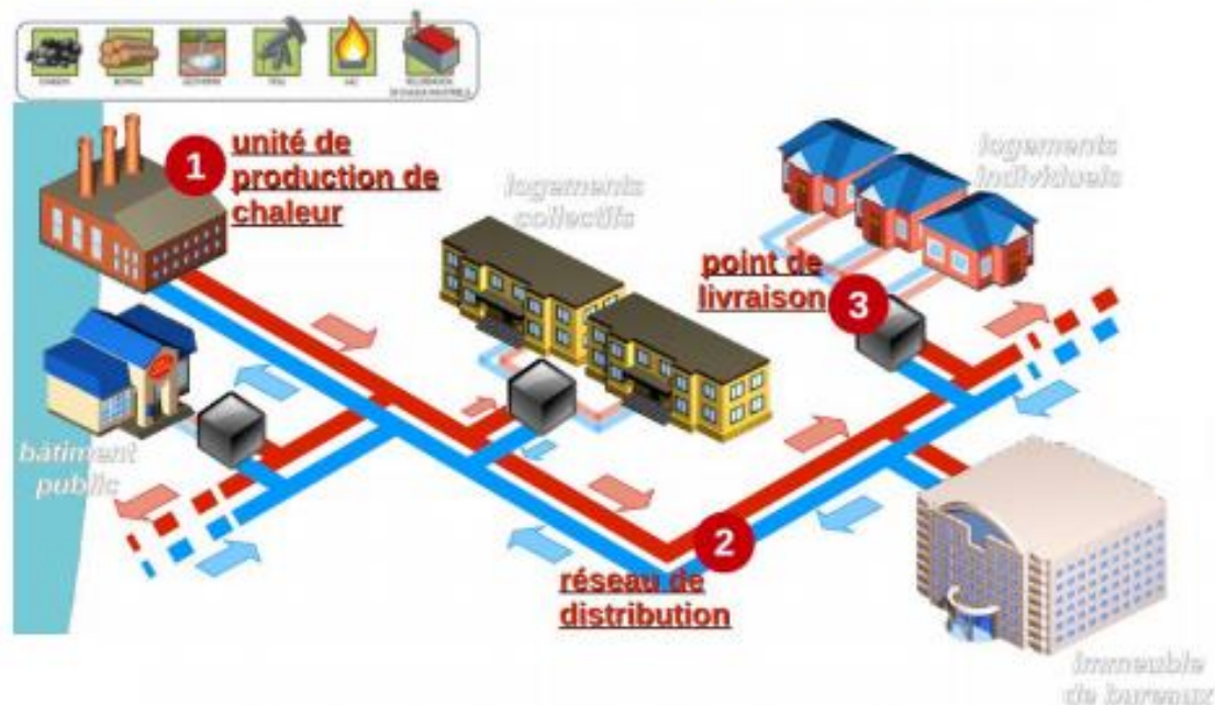
Fig. 16. Schéma de principe d'un réseau de chaleur
