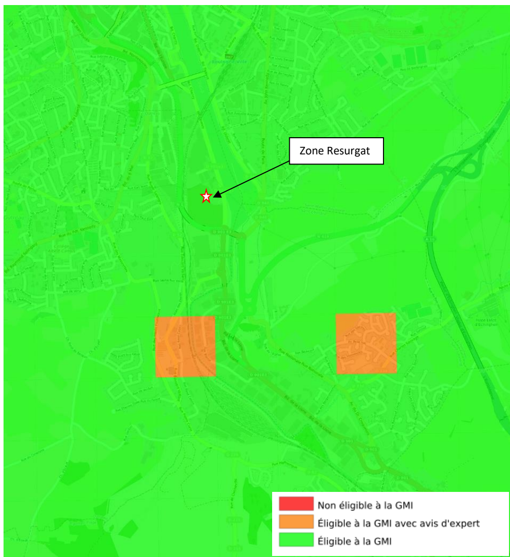
Figure 17 : Zones réglementaires GMI (initiales et révisées) pour les échangeurs fermés jusqu'à 100 m
