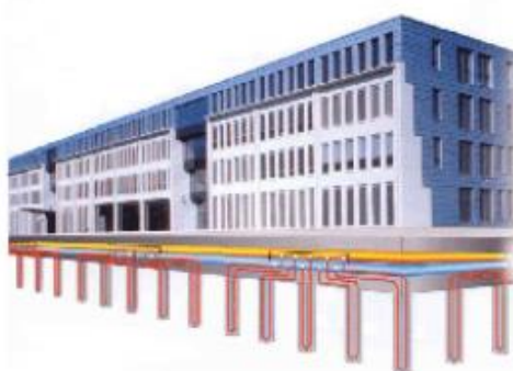
Figure 38 : Schéma d'utilisation de pieux géothermiques verticaux dans les fondations du bâtiment
