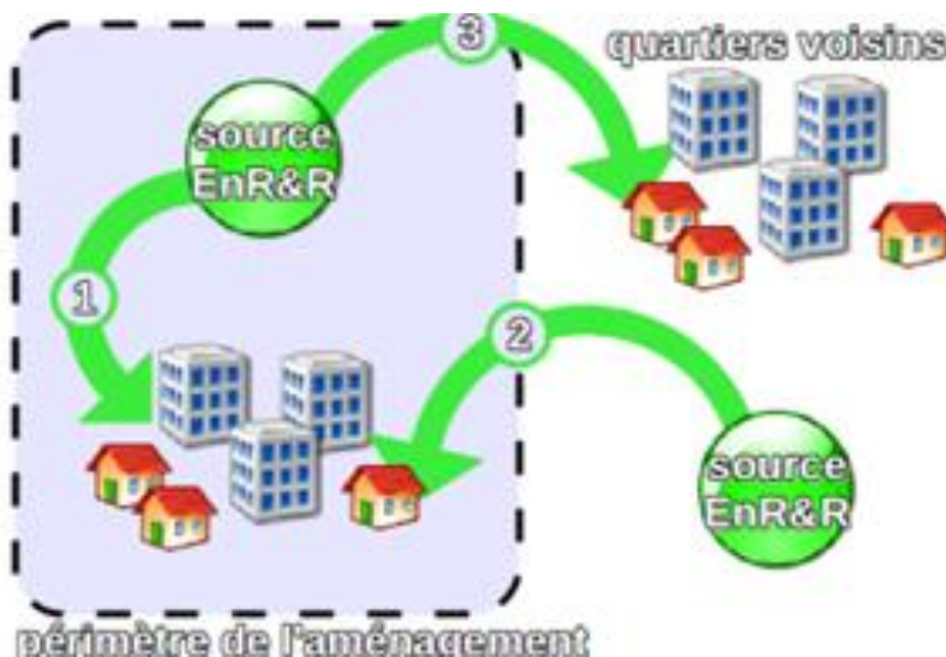
Figure 27 : Schéma de principe de mutualisation énergétique
